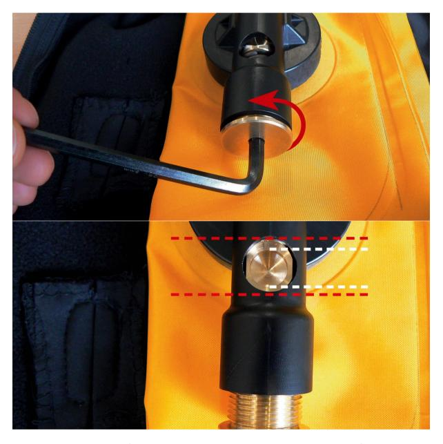
Munissez-vous de la clé Allen fournie avec votre C-Protect Air® (clé Allen de 5), puis, dévissez le bouchon jusqu'à pouvoir aligner le percuteur avec l'emplacement de l'anneau rotule.
